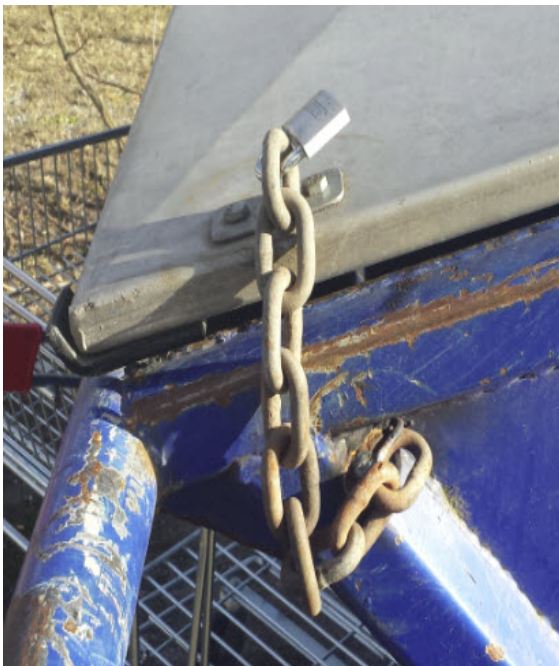
Påsvetsad, grovt dimensionerad kätting med lås.
